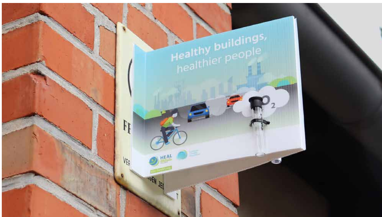
► Tubos para medir el NO 2 en el exterior de un colegio de Berlín | © HEAL |
